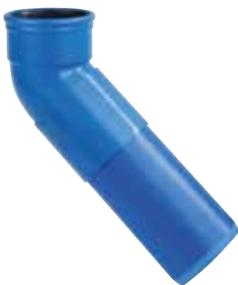
Le coude allongé à 45° du DykaSono est un accessoire spécialement conçu pour l'aval du tube de descente. Grâce au prolongement du coude, vous pouvez facilement créer une pièce intermédiaire d'au moins 250 mm, comme l'exigent les instructions d'installation. Cet accessoire permet également de
