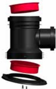
**1** Desserrez les vis du dessous. Placez deux couvercles de protection. Remplacez la bride et resserrez les vis.
