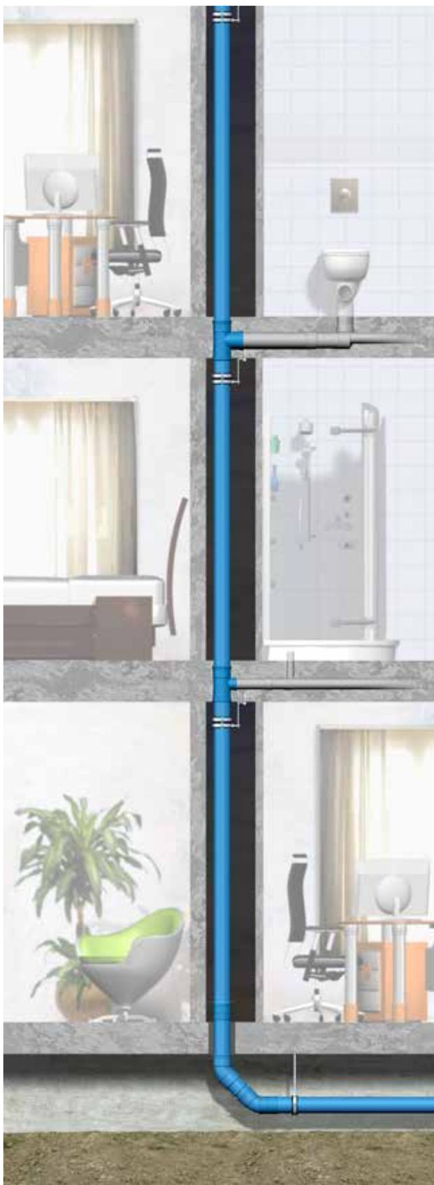
*Installation d'un tube de descente dans un conduit à double point fixe supporté au niveau du plafond.*
