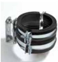
Une fois installé, le collier à point fixe repose entièrement sur le collier coulissant, assurant ainsi un isolement acoustique optimal. Le double collier à point fixe devra être monté sur un mur ou une structure solide.
