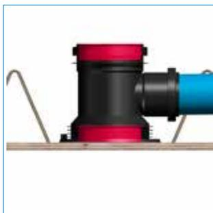
**2** Raccordez le tube horizontal et fixez la structure au sol afin d'éviter le flottement.
