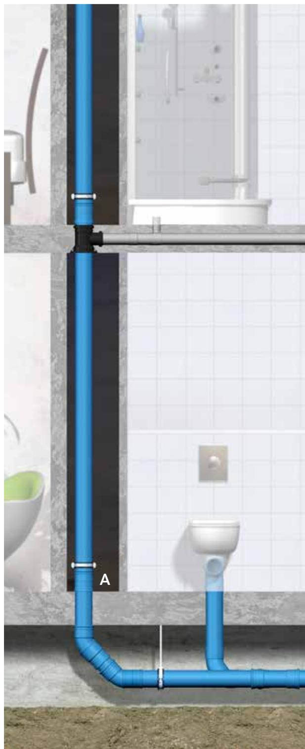
*Support de point de fixation au-dessus du manchon de dilatation (A) pour éviter qu'il ne soit endommagé.*
