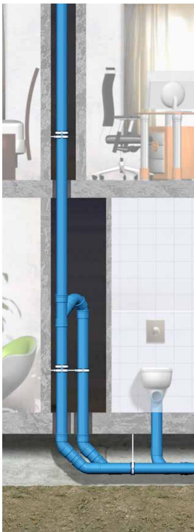
*Installation d'un tube de descente dans un conduit avec un tube parallèle pour des toilettes.*
