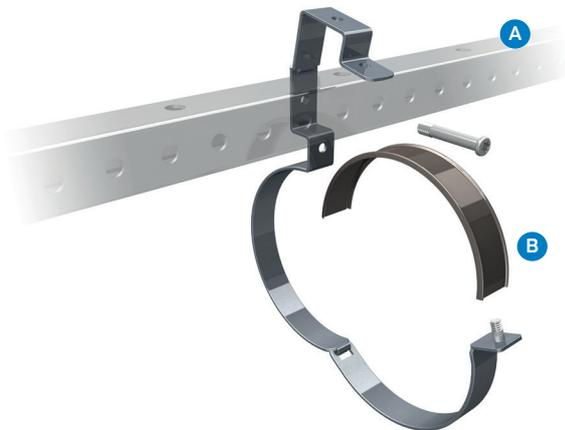
1. Retirez le boulon de la bride sur la partie supérieure de l'étrier et clipsez la bride par dessus les rails.
