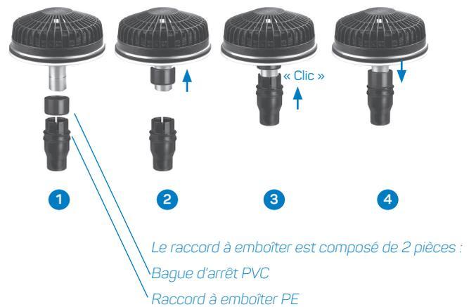
En fonction de la distance entre l'entonnoir et le collecteur, la conduite de raccordement doit être installée de manière différente. L'illustration ci-dessous vous indique comment.
