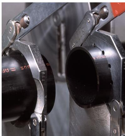
3. Montez les plaques de serrage du diamètre souhaité et alignez-les.
